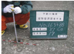
箱尺・コンベックスで空洞厚を計測
