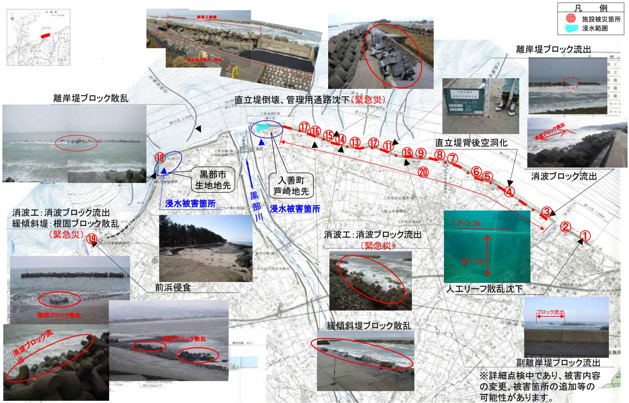
入善町神子沢地区では堤防が陥没、消波ブロックや護岸ブロックの流出・散乱が発生
