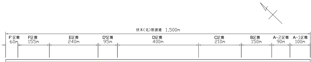
図 2-3 北防波堤の設計区間の区割り (平面図)
