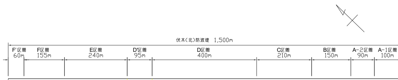
図 1.2-1 北防波堤の設計区間の区割り（平面図）
