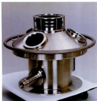
海象計の海底設置センサー部
